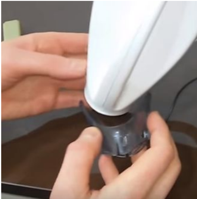
7. снять защиту 2-х стороннего скотча с блока питания
