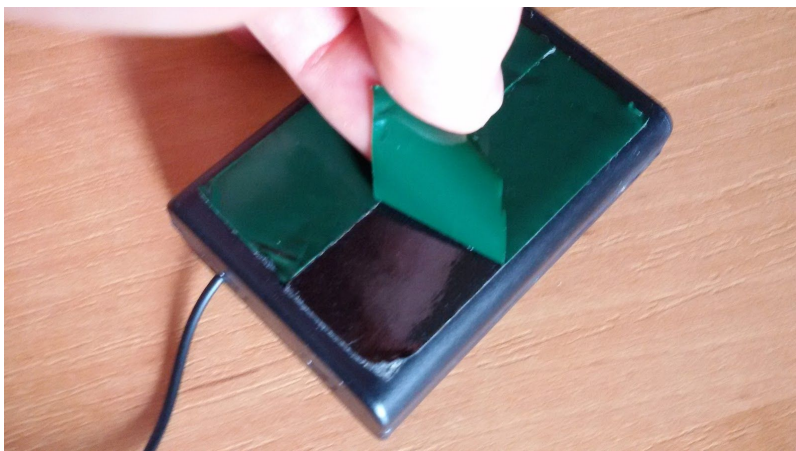
7. снять защиту 2-х стороннего скотча с блока питания
